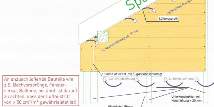
An anschließende Bauteile wie z.B. Dachvorsprünge, Fenstersimse, Balkone, od. ähnl. ist darauf zu achten, dass der Luftaustritt von > 50 cm<sup>2</sup>/m\* gewährleistet ist!
